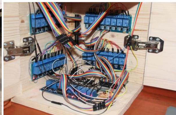
Schaltzentrale der Magnetroboter
